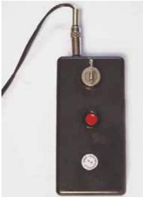
*Abb. 20: Batteriebetriebene Zündvorrichtung für Kanone mit elektrischer Zündung*
