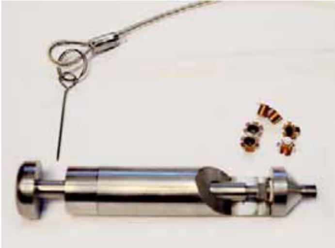
Abb. 18: Mechanische Zündvorrichtung
