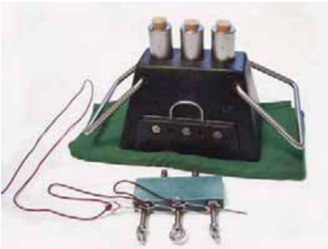
Abb. 21: Dreirohriger Standbölller mit mechanischer Zündung und Abzugsleine
