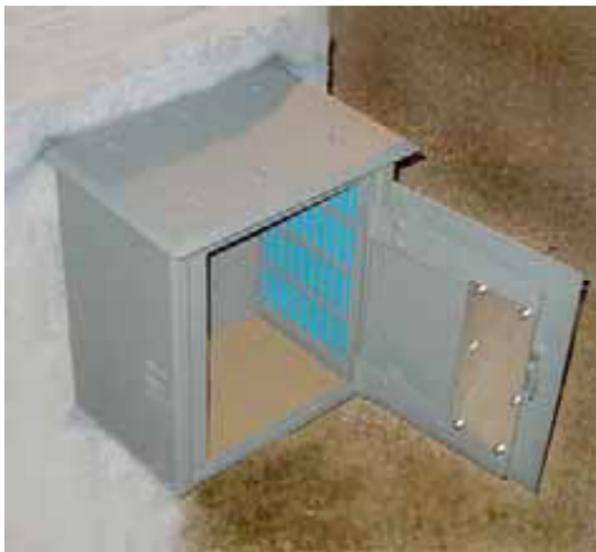
*Abb. 4: Stahl-Behältnis zum Aufbewahren von Böllerpulver
