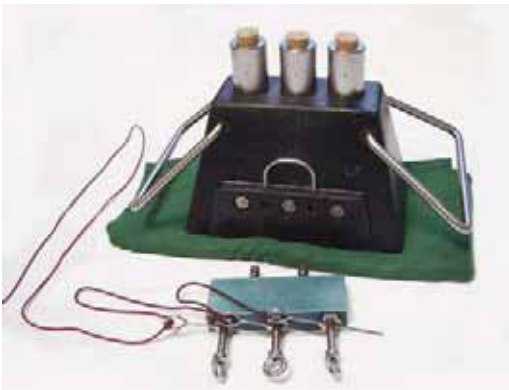
Abb. 21: Dreirohriger Standbölller mit mechanischer Zündung und Abzugsleine
