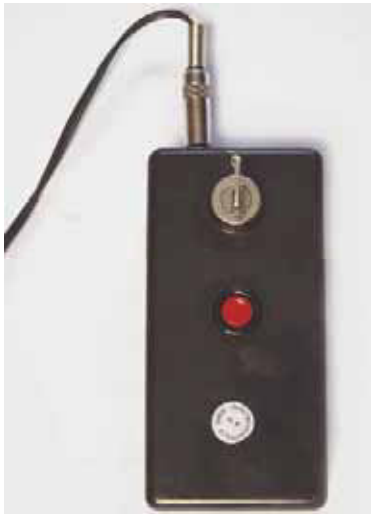
Abb. 20: Batteriebetriebene Zündvorrichtung für Kanone mit elektrischer Zündung
