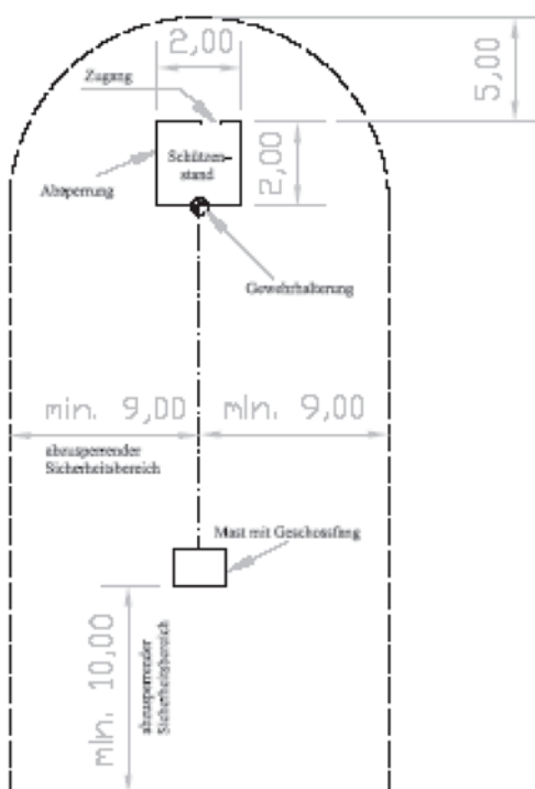
Abbildung 7.9.1 Sicherheitsbereich für Vogelschießstände
